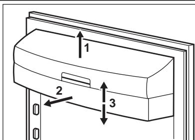
Чтобы обеспечить возможность хранения упаковок продуктов различных размеров, полки дверцы можно размещать на разной высоте. Чтобы переставить полку, действуйте следующим образом:
